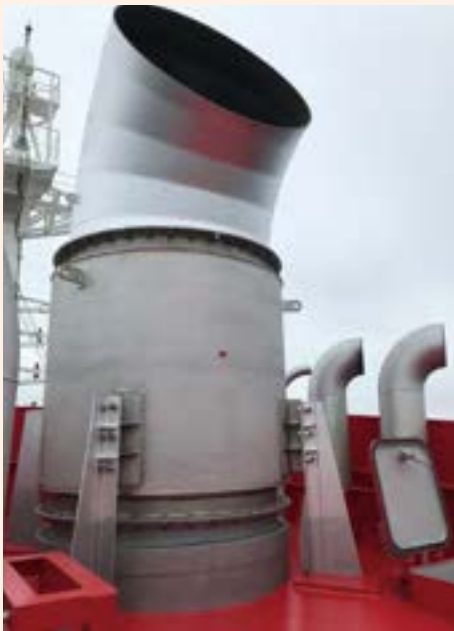
船舶に搭載されたサイレンサー
