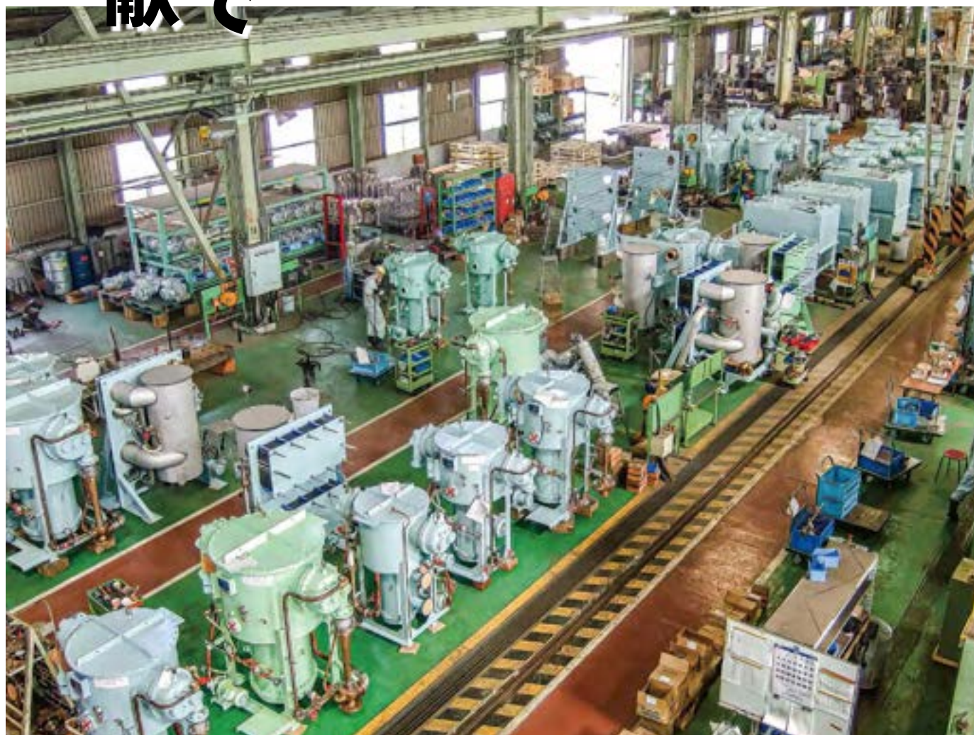
小野田工場に主力の船舶用造水装置や汚水処理装置などがずらりと並ぶ様子
