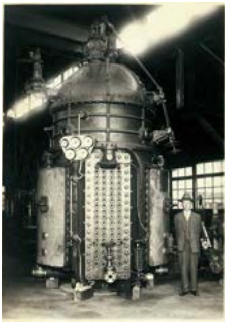
“初代”の船舶用造水装置である、100トン/日の蒸化器と写真に納まる創業者の笹倉敏郎氏
